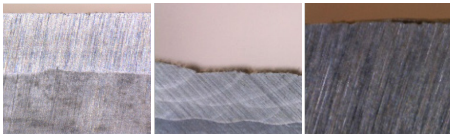
Verskillende cladlagen, op verschillende vergrotingen, contouren en overgangslagen duidelijk zichtbaar.
