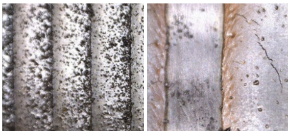
Oppervlakte van een zuiver cobalt-chroom cladlaag (links) , scheurvorming in een martensitisch RVS 431 laag (rechts).
